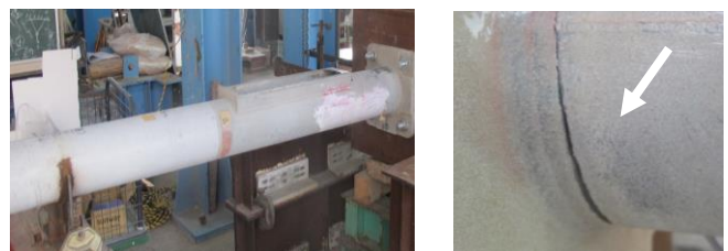
図-9 リブ無の試験終了時亀裂
