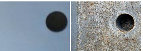
図 3.4 琉大曝露試験 異種金属 炭素鋼
