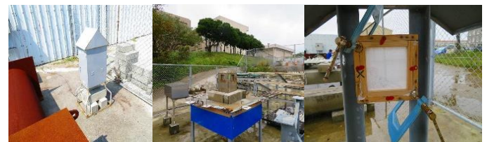
写真 2.3 設置状況(左からエアサンプラー, 土研式タンク法, ドライガーゼ法(捕集面は南北))
