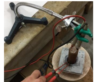
図-3.2 現場を想定した抵抗計測の様子
