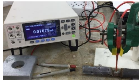
図-2.3.2 抵抗値計測時の様子 φ10mm;25%減肉
