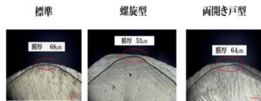
写真 - 3 移動経路による角部断面
