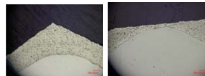
写真 - 4 重ね施工あり (左) 重ね施工なし (右)
