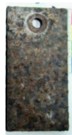
写真-10 那覇港暴露場雨がかりなし偏光顕微鏡観察
