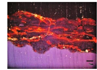
写真-9 琉大暴露場雨がかりなし偏光顕微鏡観察
