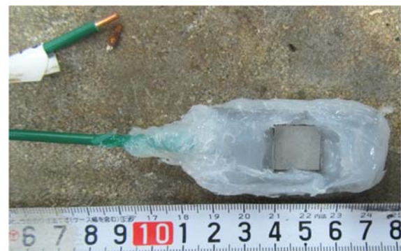
写真-3 自然電位測定用試験片
