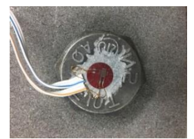
写真-4 ボルト頭部ひずみゲージ
