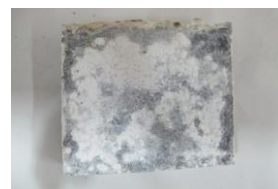
SZ 試験体（5%塩水塗布）1500h
