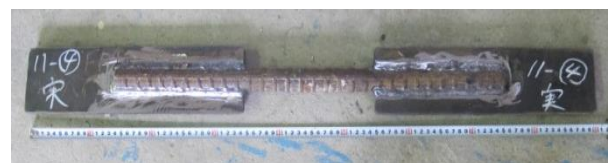
写真 - 2. 疲労強度試験体
