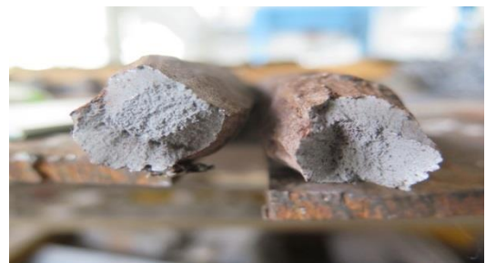
写真 - 3. 試験体破断面（引張強度試験）
