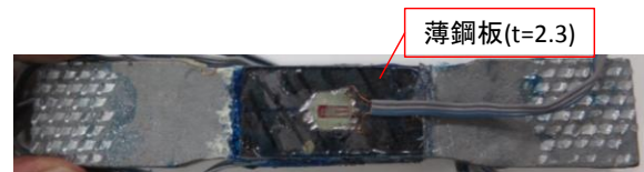
写真3 補修後試験体
