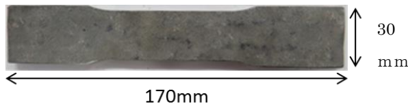
写真1 腐食試験片 (板厚 9.0 mm相当)
