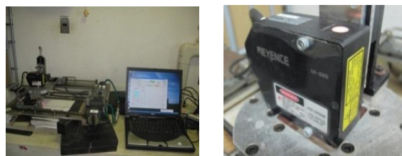
写真2 レーザーシステムとレーザー変位計
