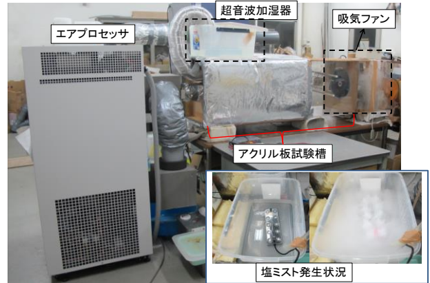
写真5 潮風腐食促進試験装置
