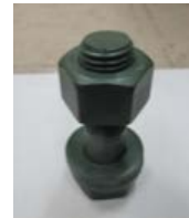
写真1 防錆処理ボルト 写真2 沖縄県で腐食したボルト
