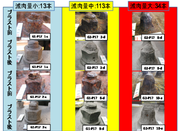
図4 腐食劣化分類
