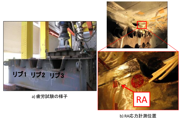
写真 4.1 疲労試験の様子
