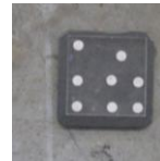
③画像接続用の コードターゲット (6mm径の円が並ぶ)
