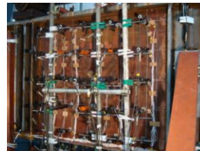
写真3 CDP変位計設置状況(ウェブ裏面)
