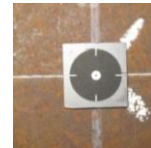
②計測点用ターゲット 円形の直径3・6・12mm 厚さ1mm
