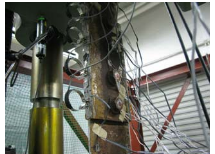
写真4 腐食試験体引張試験状況
