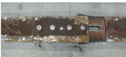
写真 6 引張試験後腐食試験体
