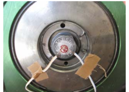
写真2 2軸ゲージ貼付ボルトと軸力計
