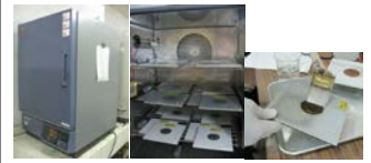
写真1 恒温恒湿器及び塩水塗布
