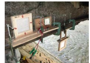
写真3 ドライガーゼ法による飛来塩分捕集
