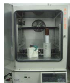
写真-4 恒温恒湿器
