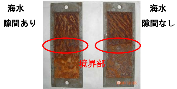
写真-6 水槽降水促進試験 概観写真
