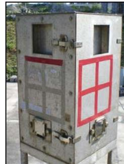
写真1 飛来塩分捕集器
